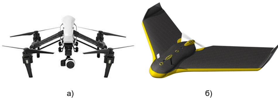
Фиг. 9. Представители от категория малки дроне а) DJI Inspire 1 V2 - квадрокоптер; б) eBee Ag - с фиксирано крило
